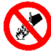
Prohibido apagar con agua
